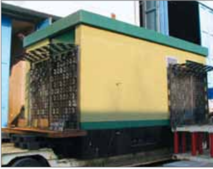
Typenprüfung einer Trafostation entsprechend der Norm DIN EN 62271-200. Die Indikatoren an den Öffnungen geben Aufschluss über die Temperaturen und Drücke nach dem Test. Im Ergebnis führt eine Bewertung zur Vergabe eines Typenschildes, wie z.B. IAC A FLR 21 kA 1s.
