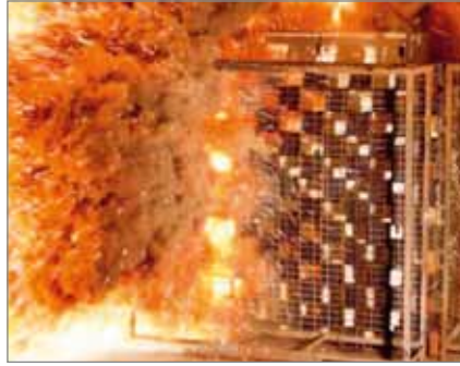
Oben: Kurzschlusslichtbogen bei einer Typenprüfung im Labor. Rechts: Die Ausdehnungskurve des Druckanstiegs bei einem Störlichtbogen. Der Höchstwert beträgt hier ca. 40 mbar innerhalb von 200 ms, was zum Zerstören einer bewehrten Ziegelwand ausreicht. Hier sind weitere Maßnahmen zur Druckbegrenzung notwendig.
